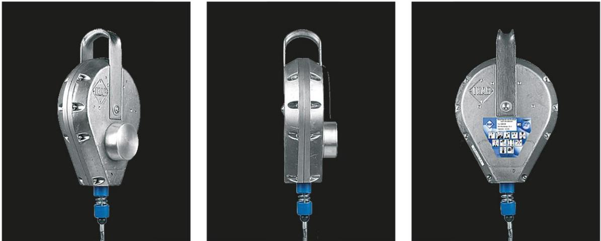
Diese Geräte funktionieren wie herkömmliche Höhensicherungsgeräte, lassen die verunfallte Person nach dem Auffangvorgang jedoch mit einer Geschwindigkeit von ca. 0,9 m/sec sicher nach unten sinken.
